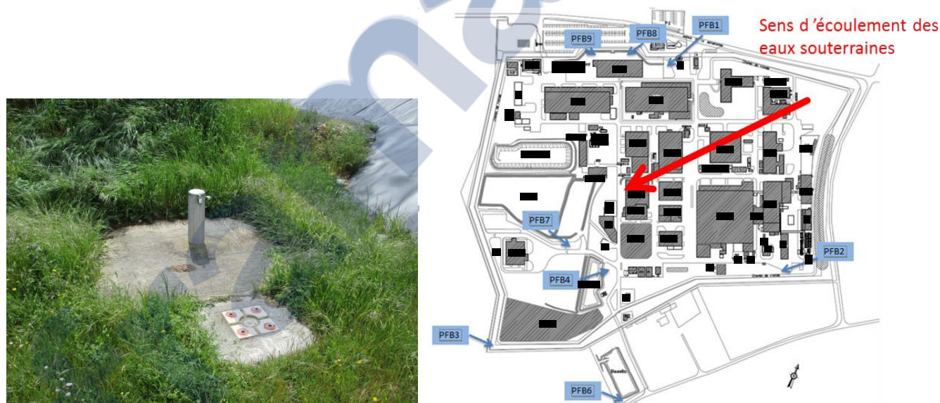
Figure U : Piézomètre et localisation des points de surveillance des eaux souterraines sur site
